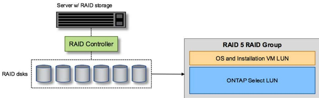
Le provisionnement des LUN de système d'exploitation à partir du même groupe RAID que ONTAP Select permet à l'OS de l'hyperviseur (et à toute machine virtuelle client qui est également provisionnée à partir de ce stockage) de bénéficier de la protection RAID. Cette configuration évite qu'une panne de disque unique n'entraîne l'arrêt du système dans son ensemble.
