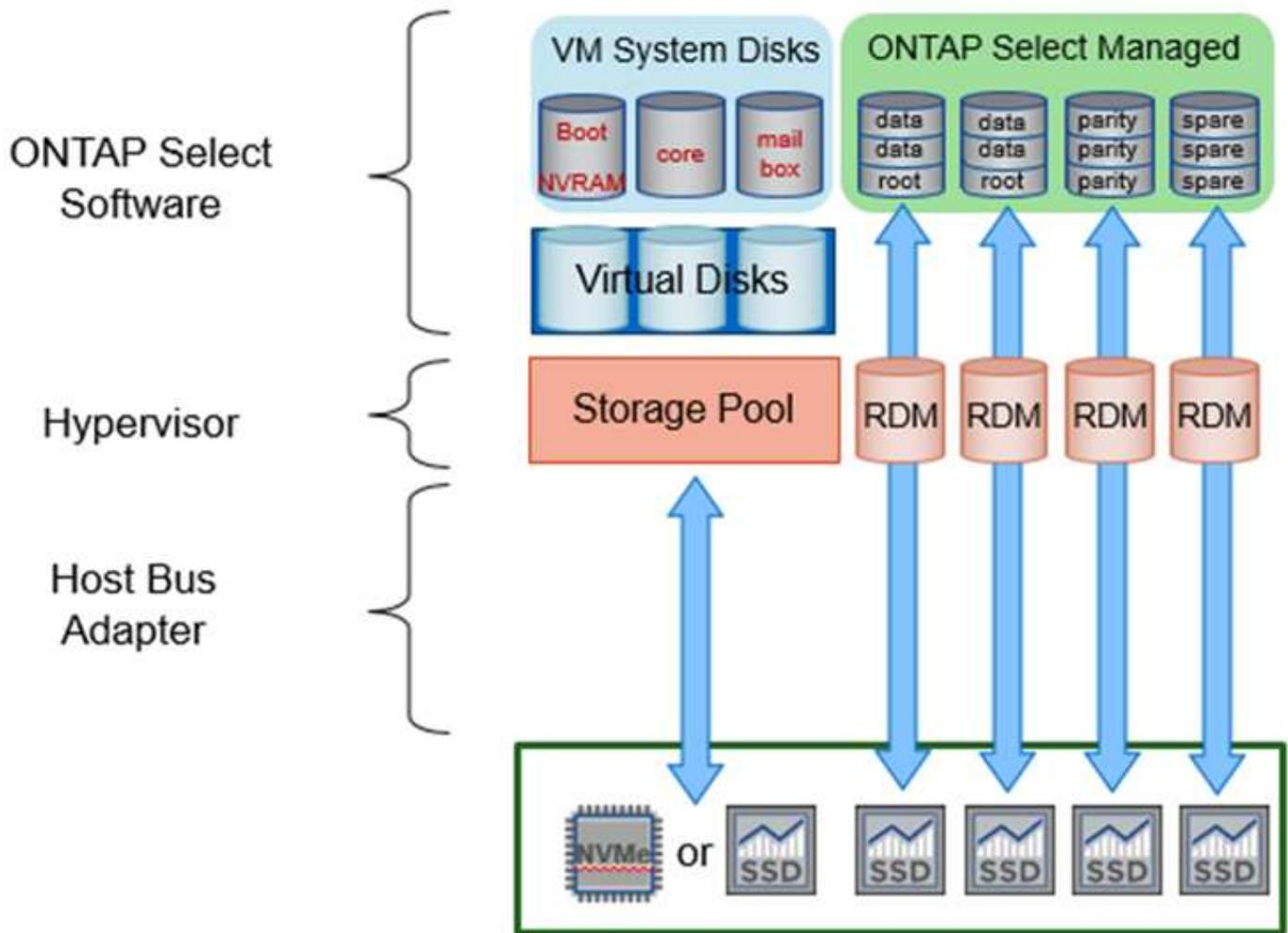
Les disques système (VMDK) résident dans le même datastore et sur le même disque physique. Le disque NVRAM virtuel requiert un support rapide et durable. Par conséquent, seuls les datastores NVMe et de type SSD sont pris en charge.
