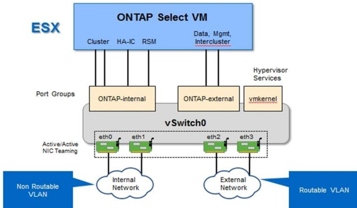
La segmentation du trafic interne et externe entre différentes cartes réseau physiques empêche l'introduction de latences dans le système en raison d'un accès insuffisant aux ressources réseau. En outre, l'agrégation via le regroupement de cartes réseau garantit que la défaillance d'une seule carte réseau n'empêche pas le nœud de cluster ONTAP Select d'accéder au réseau correspondant.
