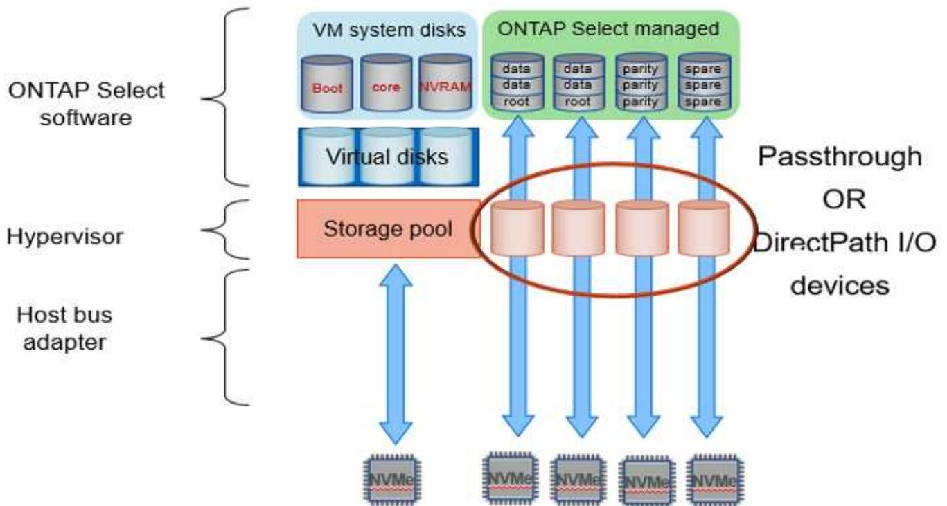
Les disques système (VMDK) résident dans le même datastore et sur le même disque physique. Le disque NVRAM virtuel requiert un support rapide et durable. Par conséquent, seuls les datastores NVMe et de type SSD sont pris en charge. Lorsque vous utilisez des disques NVMe pour les données, le disque du système doit également être un périphérique NVMe pour des raisons de performance. Les cartes INTEL Optane sont un bon candidat pour le disque système dans une configuration 100 % NVMe.
