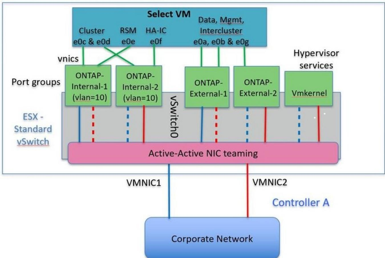
Lorsque vous utilisez deux ports physiques (10 Go ou moins), chaque port group doit disposer d'un adaptateur actif et d'un adaptateur de secours configuré l'un en face de l'autre. Le réseau interne n'est présent que pour les clusters ONTAP Select à plusieurs nœuds. Dans le cas des clusters à un seul nœud, les deux adaptateurs peuvent être configurés comme actifs dans le port group externe.
