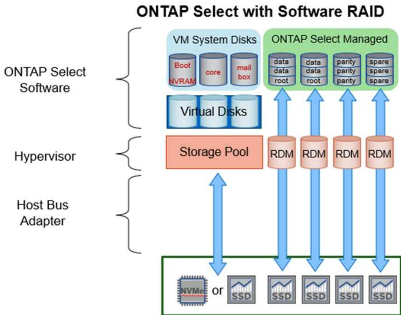
Les disques système (VMDK) résident dans le même datastore et sur le même disque physique. Le disque NVRAM virtuel requiert un support rapide et durable. Par conséquent, seuls les datastores NVMe et de type SSD sont pris en charge.
