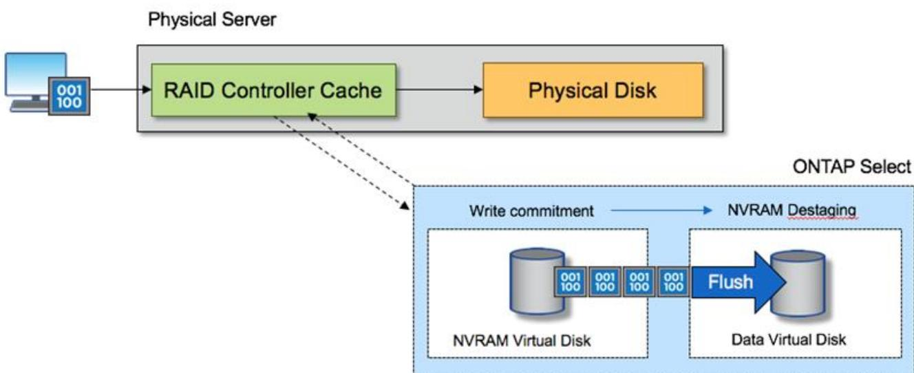
La partition NVRAM est séparée sur son propre VMDK. Ce VMDK est attaché à l'aide du pilote vNVME disponible dans les versions ESX de 6.5 ou ultérieure. Ce changement est particulièrement important pour les installations ONTAP Select avec RAID logiciel, qui ne bénéficient pas du cache du contrôleur RAID.
