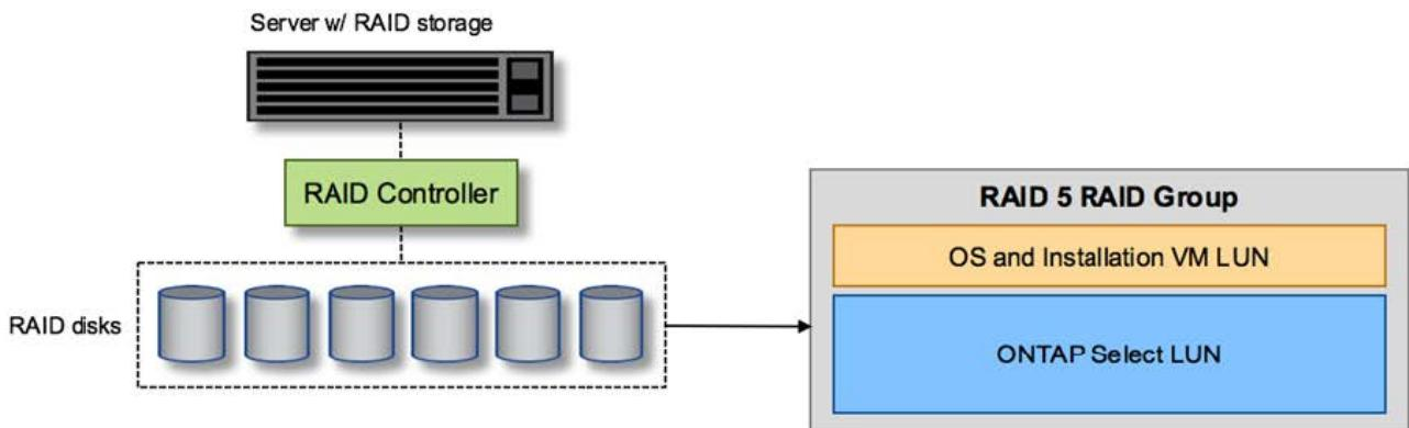
Le provisionnement des LUN de système d'exploitation à partir du même groupe RAID que ONTAP Select permet à l'OS de l'hyperviseur (et à toute machine virtuelle client qui est également provisionnée à partir de ce stockage) de bénéficier de la protection RAID. Cette configuration évite qu'une panne de disque unique n'entraînent l'arrêt du système dans son ensemble.
