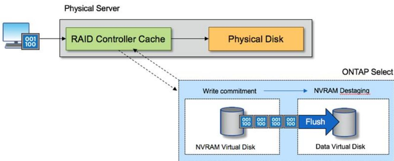
**Informations** La partition NVRAM est séparée sur son propre VMDK. Ce VMDK est attaché à l'aide du pilote vNVME disponible dans les versions ESX de 6.5 ou ultérieure. Ce changement est particulièrement important pour les installations ONTAP Select avec RAID logiciel, qui ne bénéficient pas du cache du contrôleur RAID.
