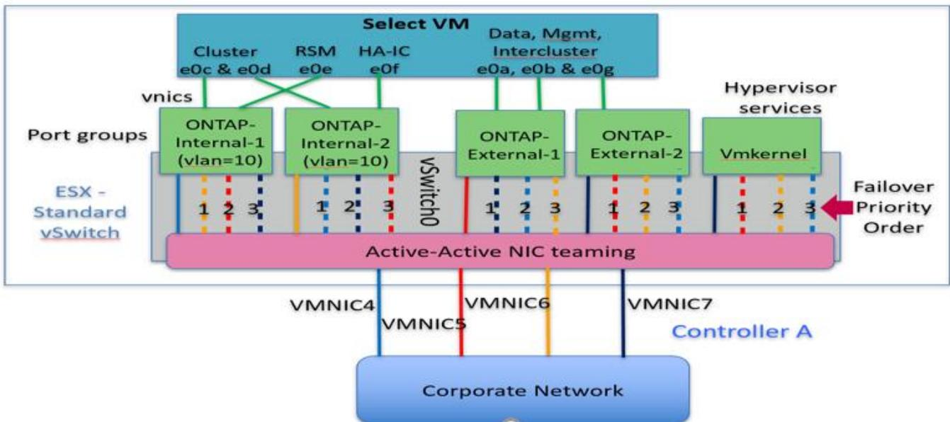
L'ordre des ports dans la liste de secours est important. Le tableau suivant fournit un exemple de distribution physique des ports entre les quatre groupes de ports.
