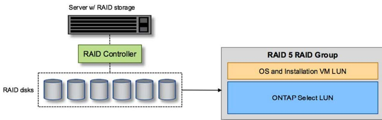
Le provisionnement des LUN de système d'exploitation à partir du même groupe RAID que ONTAP Select permet à l'OS de l'hyperviseur (et à toute machine virtuelle client qui est également provisionnée à partir de ce stockage) de bénéficier de la protection RAID. Cette configuration évite qu'une panne de disque unique n'entraînent l'arrêt du système dans son ensemble.
