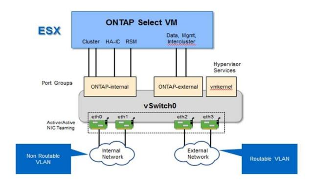
La segmentation du trafic interne et externe entre différentes cartes réseau physiques empêche l'introduction de latences dans le système en raison d'un accès insuffisant aux ressources réseau. En outre, l'agrégation via le regroupement de cartes réseau garantit que la défaillance d'une seule carte réseau n'empêche pas le nœud de cluster ONTAP Select d'accéder au réseau correspondant.
