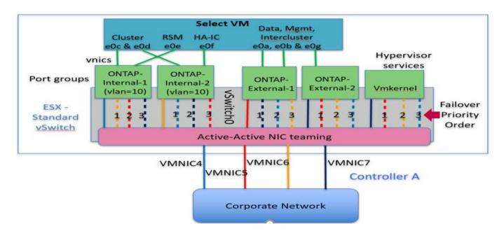
L'ordre des ports dans la liste de secours est important. Le tableau suivant fournit un exemple de distribution physique des ports entre les quatre groupes de ports.
