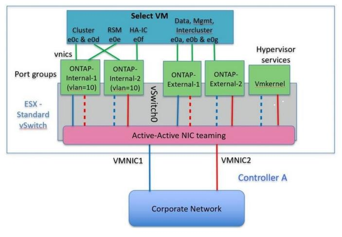
Lorsque vous utilisez deux ports physiques (10 Go ou moins), chaque port group doit disposer d'un adaptateur actif et d'un adaptateur de secours configuré l'un en face de l'autre. Le réseau interne n'est présent que pour les clusters ONTAP Select à plusieurs nœuds. Dans le cas des clusters à un seul nœud, les deux adaptateurs peuvent être configurés comme actifs dans le port group externe.
