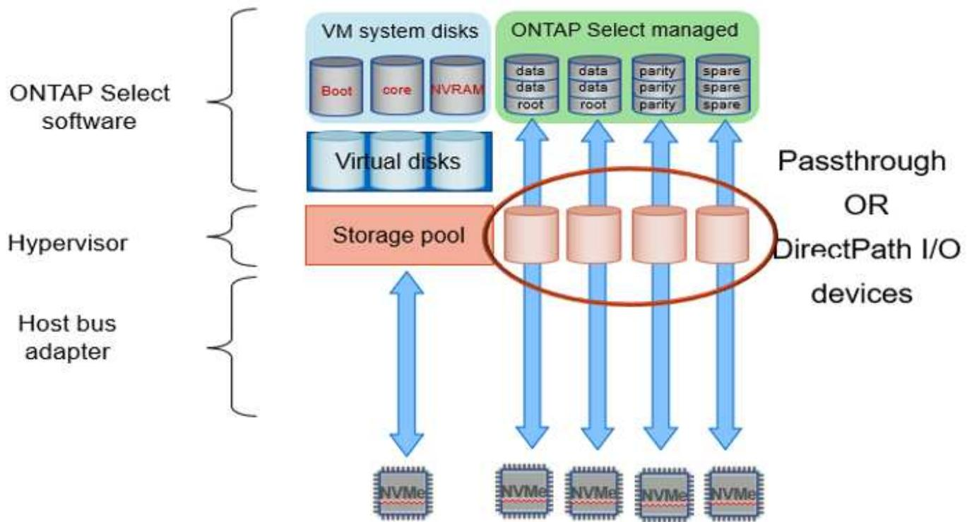
Les disques système (VMDK) résident dans le même datastore et sur le même disque physique. Le disque NVRAM virtuel requiert un support rapide et durable. Par conséquent, seuls les datastores NVMe et de type SSD sont pris en charge. Lorsque vous utilisez des disques NVMe pour les données, le disque du système doit également être un périphérique NVMe pour des raisons de performance. Les cartes INTEL Optane sont un bon candidat pour le disque système dans une configuration 100 % NVMe.
