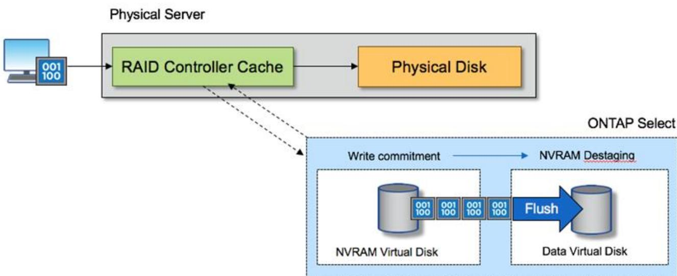
La partition NVRAM est séparée sur son propre VMDK. Ce VMDK est attaché à l'aide du pilote vNVME disponible dans les versions ESXi 8.0 ou ultérieures. Ce changement est particulièrement important pour les installations ONTAP Select avec RAID logiciel, qui ne bénéficient pas du cache du contrôleur RAID.
