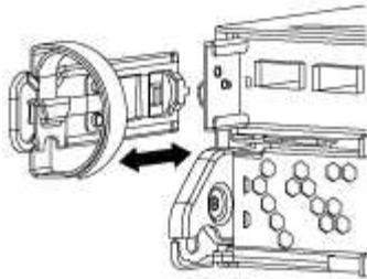
3. Appuyez sur le loquet de la poignée de came jusqu'à ce qu'il se libère, ouvrez complètement la poignée de came pour libérer le module de contrôleur du fond de panier central, puis, à l'aide de deux mains, retirez le module de contrôleur du châssis.
