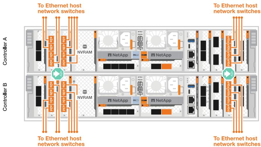
3. Utilisez les câbles 1000BASE-T RJ-45 pour connecter les ports de gestion du contrôleur (clé anglaise) aux commutateurs du réseau de gestion.
