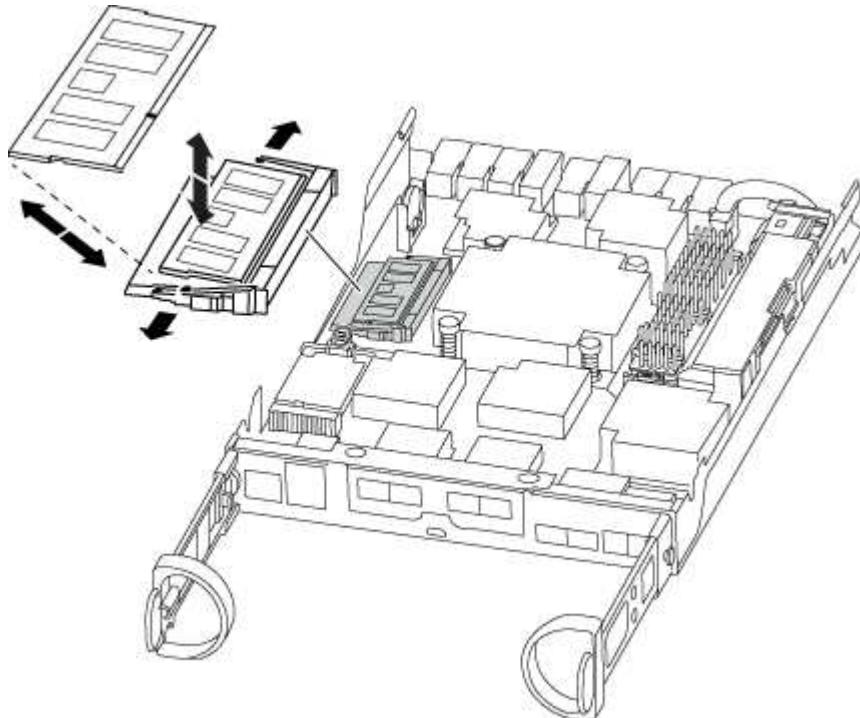
4. Répétez ces étapes pour retirer d'autres modules DIMM si nécessaire.
