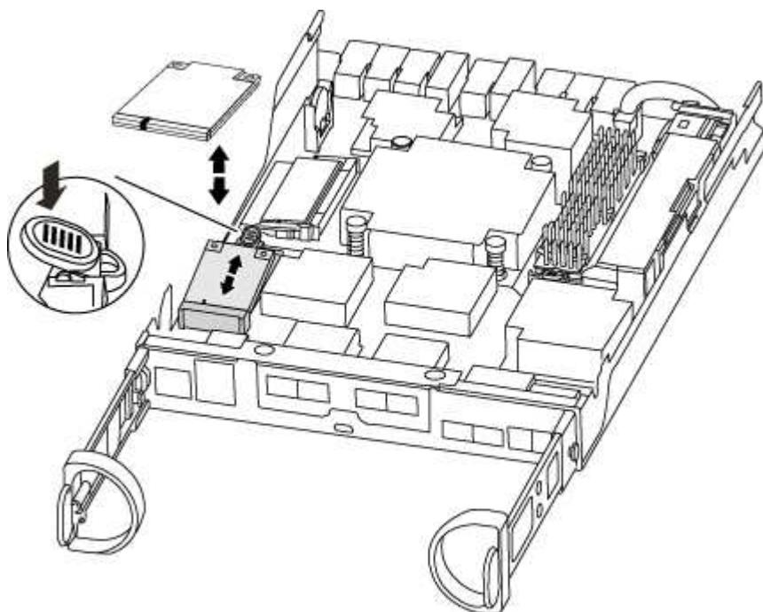
2. Appuyez sur le bouton bleu du logement du support de démarrage pour libérer le support de démarrage de son logement, puis tirez-le doucement hors du support de démarrage.
