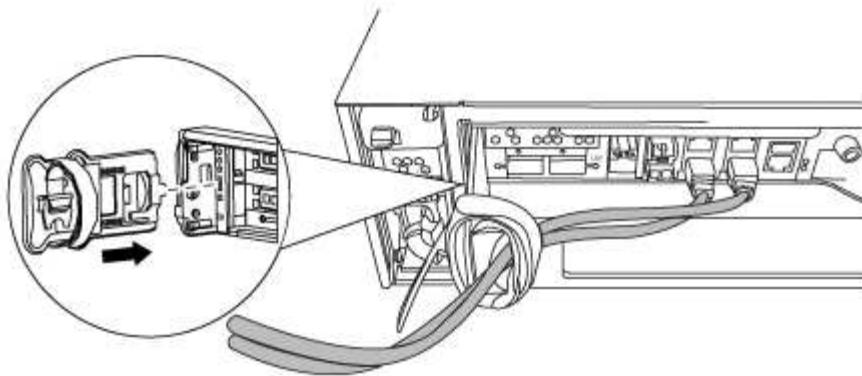
4. Desserrez la vis moletée sur la poignée de came du module de contrôleur.
