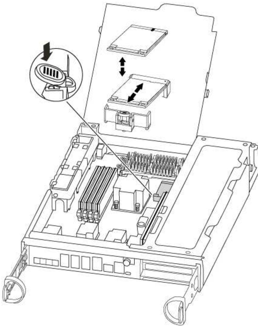
3. Appuyez sur le bouton bleu du logement du support de démarrage pour libérer le support de démarrage de son logement, puis tirez-le doucement hors du support de démarrage.
