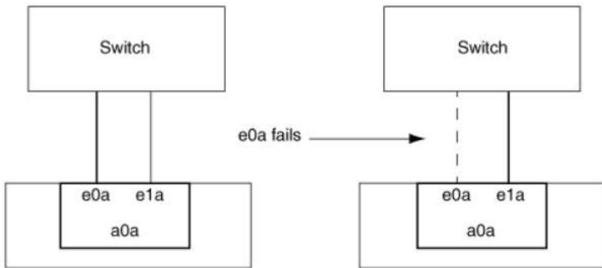
**i** Pour profiter de la fonctionnalité Single-mode, l'approche recommandée consiste à utiliser des groupes de basculement. L'utilisation d'un failover group permet de continuer à utiliser le second port pour d'autres LIFs et de ne pas avoir à le conserver. En outre, les groupes de basculement peuvent couvrir plus de deux ports et couvrir plusieurs nœuds.
