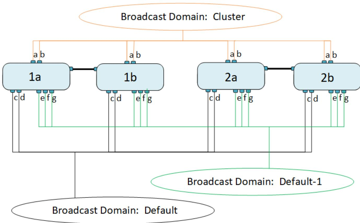
Un failover group du même nom avec les mêmes ports réseau que chacun des domaines de broadcast est créé automatiquement. Ce failover group est automatiquement géré par le système, ce qui signifie qu'à mesure que des ports sont ajoutés ou supprimés du broadcast domain, ils sont automatiquement ajoutés ou supprimés de ce failover group.
