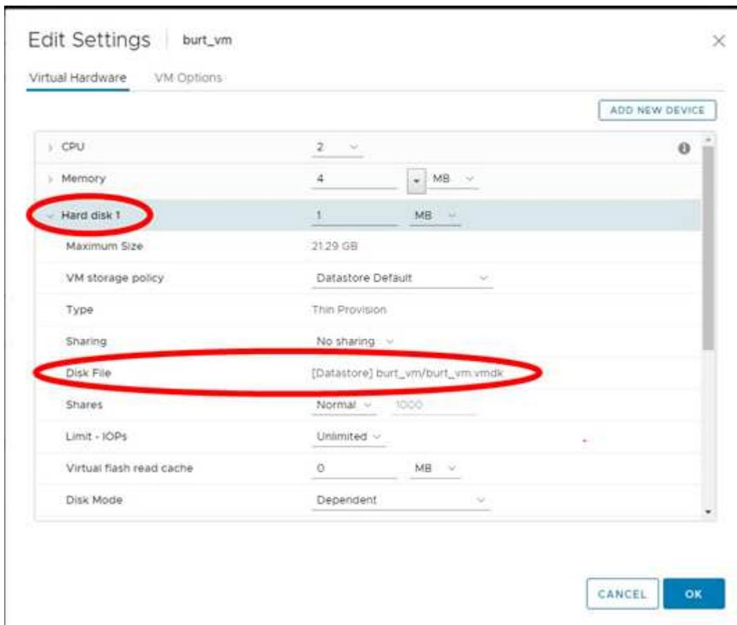
La page Modifier les paramètres répertorie les disques de la machine virtuelle. Vous pouvez développer les détails de chaque disque dur pour afficher la liste des disques virtuels connectés.
