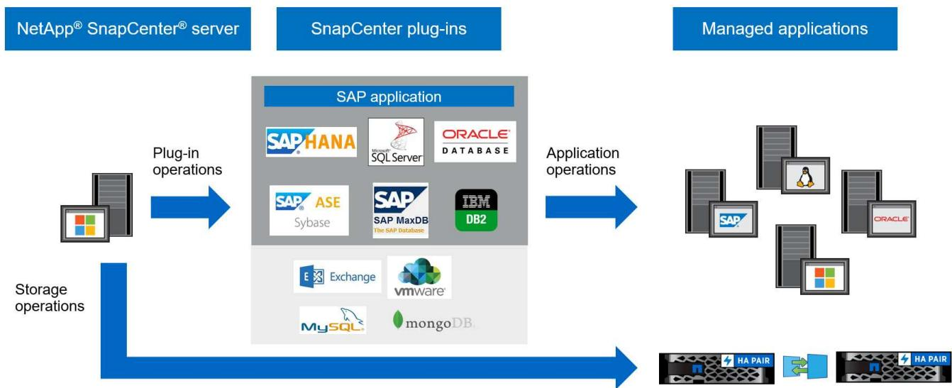
SnapCenter inclut le serveur SnapCenter , le package de plug-in SnapCenter pour Windows et le package de plug-in SnapCenter pour Linux. Chaque package contient des plug-ins pour diverses applications et composants d'infrastructure.
