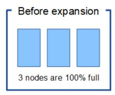
Pour développer le site dans cet exemple, il est recommandé d'ajouter au moins trois nœuds de stockage. StorageGRID a besoin de trois nœuds de stockage pour le codage d'effacement 2+1. Ainsi, il peut placer les deux fragments de données et le fragment de parité sur différents nœuds.
