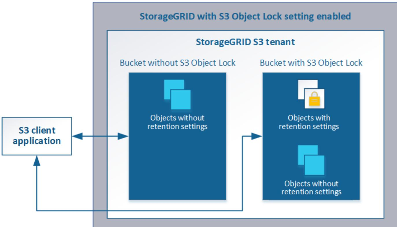
La fonctionnalité de verrouillage d'objet StorageGRID S3 fournit un mode de conservation unique équivalent au mode de conformité Amazon S3. Par défaut, une version d'objet protégé ne peut être écrasée ou supprimée par aucun utilisateur. La fonction de verrouillage d'objet StorageGRID S3 ne prend pas en charge un mode de gouvernance et n'autorise pas les utilisateurs disposant d'autorisations spéciales à contourner les paramètres de rétention ou à supprimer des objets protégés.
