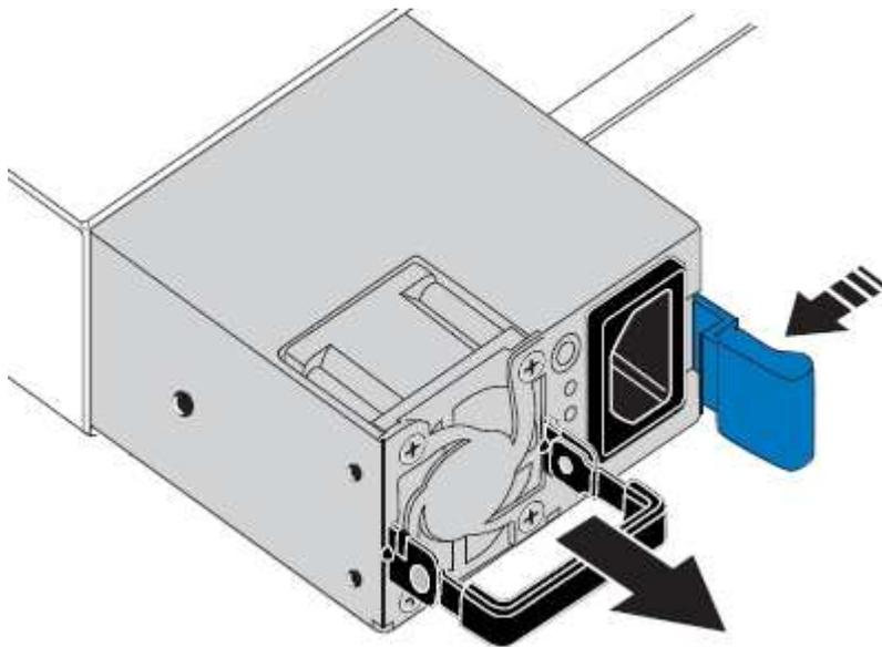
5. Avec le loquet bleu sur la droite, faites glisser le bloc d'alimentation de remplacement dans le châssis.
