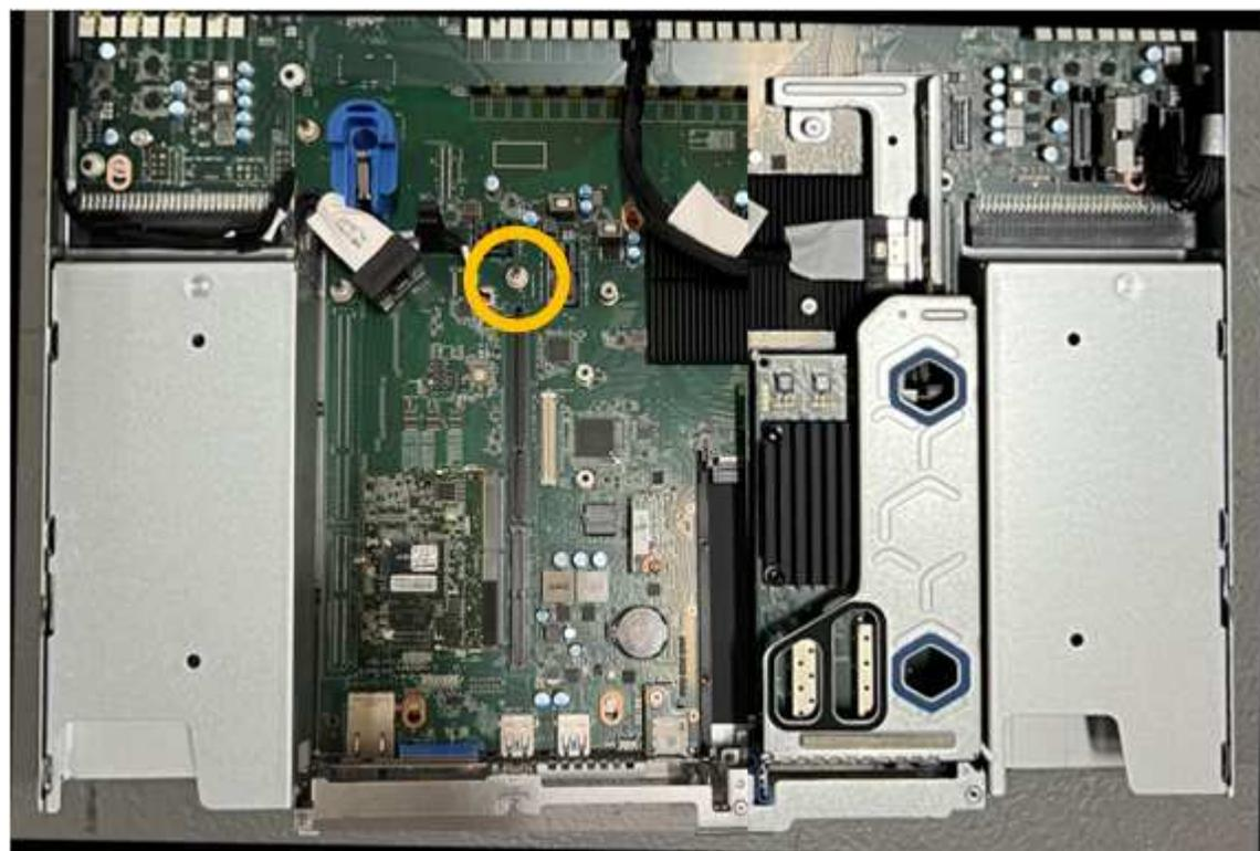
6. Positionnez l'ensemble de carte de montage dans le châssis, en vous assurant qu'il est aligné avec le connecteur de la carte système et la broche de guidage.
