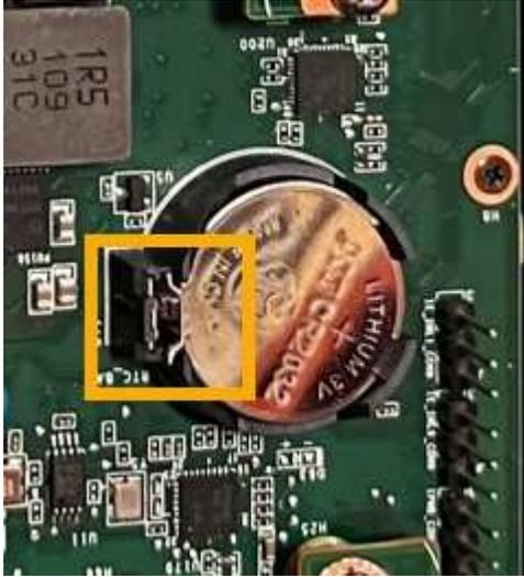
7. Retirez la batterie et mettez-la au rebut de façon appropriée.
