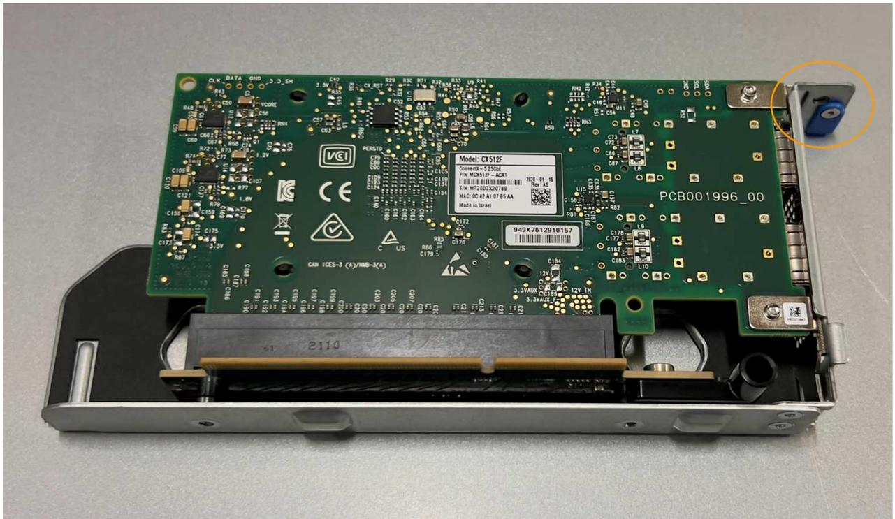
3. Ouvrez le loquet bleu (entouré) de la carte réseau à remplacer et retirez avec précaution la carte réseau de l'ensemble de carte de montage. Secouez légèrement la carte réseau pour la retirer de son connecteur. N'utilisez pas de force excessive.
