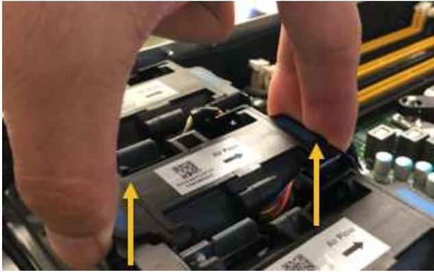
2. Faites glisser le ventilateur de remplacement dans le logement ouvert du châssis.
