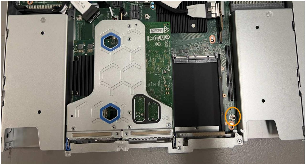
e. Positionnez l'ensemble de carte de montage à un emplacement dans le châssis, en vous assurant qu'il est aligné avec le connecteur de la carte système et la broche de guidage.
