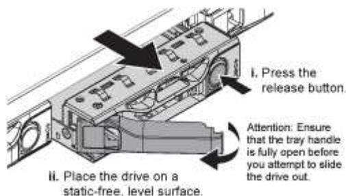
La poignée des ressorts d'entraînement s'ouvre partiellement et l'entraînement se relâche de la fente.
