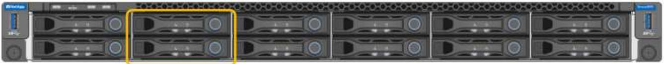
Les deux disques SSD (Solid-State Drives), indiqués par le contour orange, sont utilisés pour stocker le système d'exploitation StorageGRID et sont mis en miroir avec RAID 1 pour la redondance. Lorsque l'appliance de services SG100 ou SG1000 est configurée comme un nœud d'administration, ces disques servent à stocker les journaux d'audit, les metrics et les tables de bases de données.
