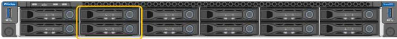
Les deux disques SSD (Solid-State Drives), indiqués par le contour orange, sont utilisés pour stocker le système d'exploitation StorageGRID et sont mis en miroir avec RAID 1 pour la redondance. Lorsque l'appliance de services SG100 ou SG1000 est configurée en tant que nœud d'administration, ces disques peuvent être utilisés pour stocker les journaux d'audit, les metrics et les tables de base de données.
