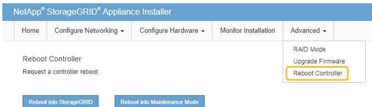
L'appliance peut redémarrer et rejoindre la grille en 20 minutes. Pour confirmer que le redémarrage est terminé et que le nœud a rejoint la grille, retournez à la grille Manager. La page nœuds doit afficher un état normal (icône en forme de coche verte) ✓ à gauche du nom du nœud) pour le nœud de l'appliance, indiquant qu'aucune alerte n'est active et que le nœud est connecté à la grille.
