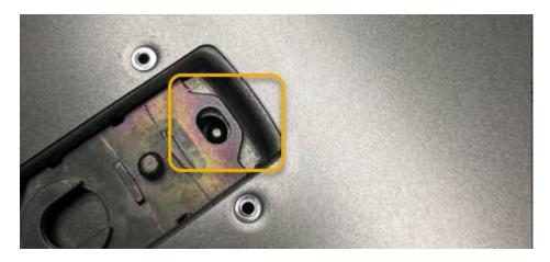
2. Faites pivoter le loquet du capot vers l'avant et vers le bas jusqu'à ce qu'il s'arrête et que le capot s'insère complètement dans le châssis. Vérifier qu'il n'y a pas d'espace le long du bord avant du couvercle.
