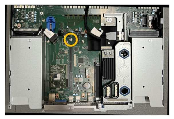
e. Positionnez l'ensemble de carte de montage dans le châssis, en vous assurant qu'il est aligné avec le
