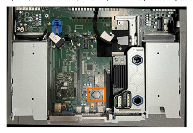
6. Utilisez votre doigt ou un levier en plastique pour écarter le clip de retenue (mis en surbrillance) de la batterie et le retirer de la prise.
