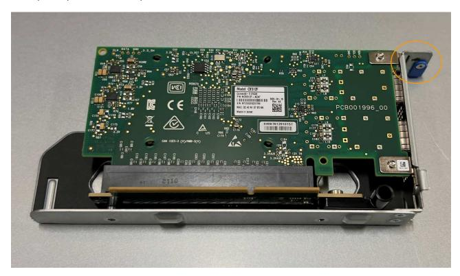
c. Repérez le trou d'alignement de l'assemblage de la carte de montage à un emplacement (encerclé) qui s'aligne sur une broche de guidage de la carte système afin de garantir un positionnement correct de l'assemblage de la carte de montage.
