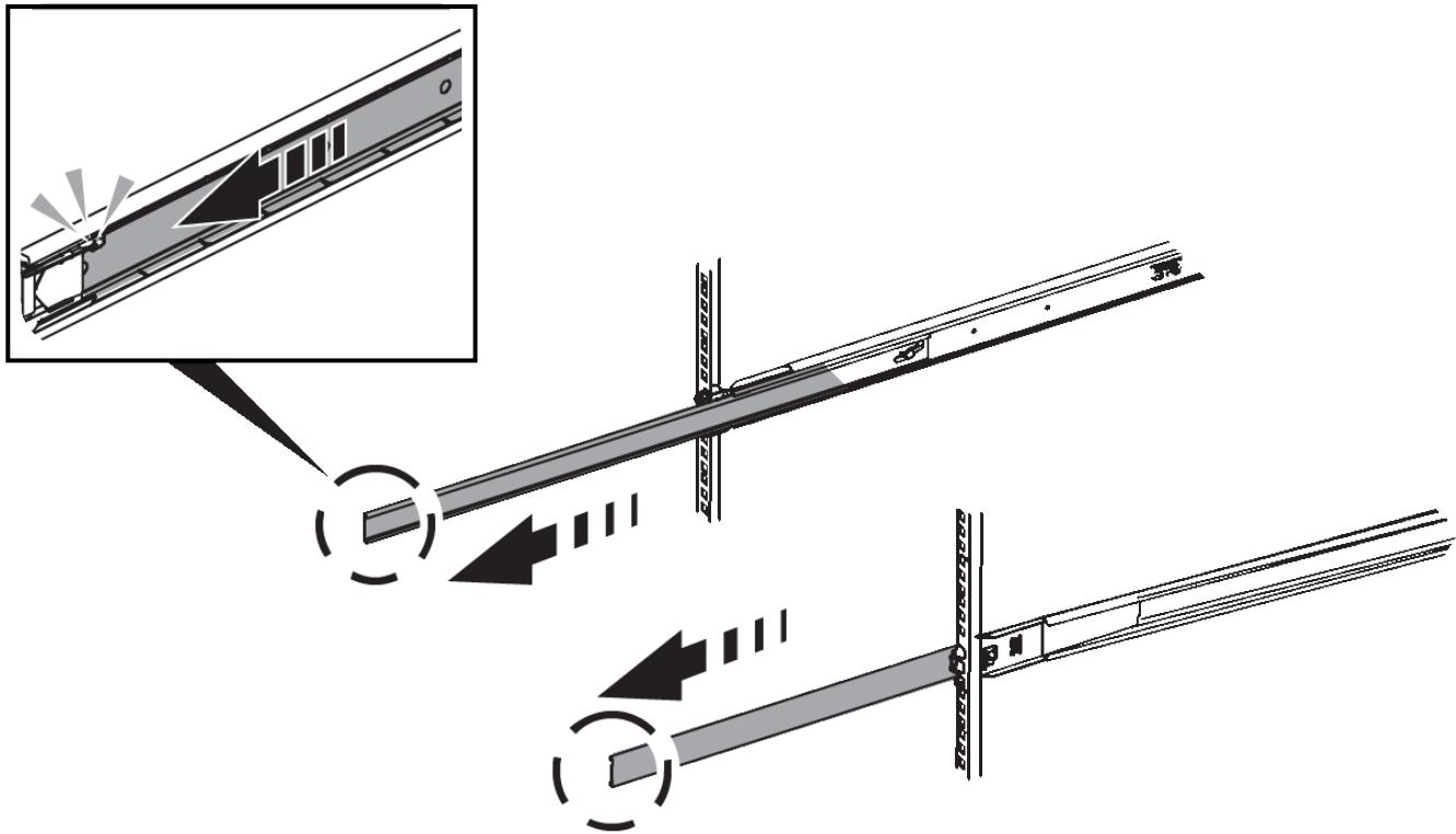
3. Insérez l'appareil dans les rails.
