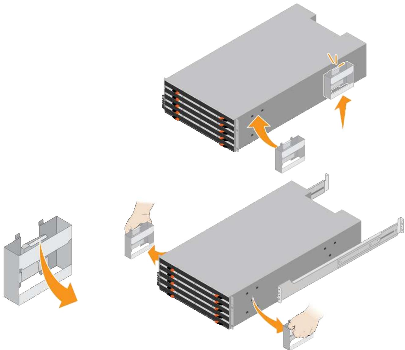
4. Placez l'arrière de la tablette (extrémité avec les connecteurs) sur les rails.
