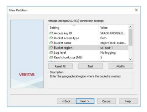
6. Pour vérifier la connexion au compartiment StorageGRID, cliquez sur Test. Vérifiez que le test de connexion a réussi. Cliquez sur OK, puis sur Suivant.
