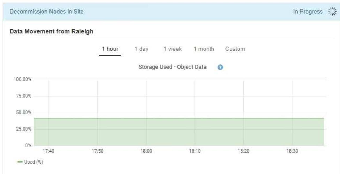
3. Dans la section progression du nœud de la page, surveillez la progression de la procédure de mise hors service lorsque les nœuds sont supprimés.
