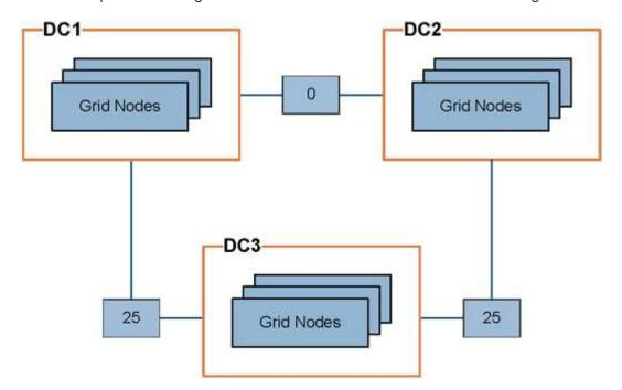
• Le service Load Balancer sur les nœuds d'administration et les nœuds de passerelle répartit uniformément les connexions client vers tous les nœuds de stockage sur le même site de data Center et vers tous les sites de data Center, avec un coût de liaison de 0.
