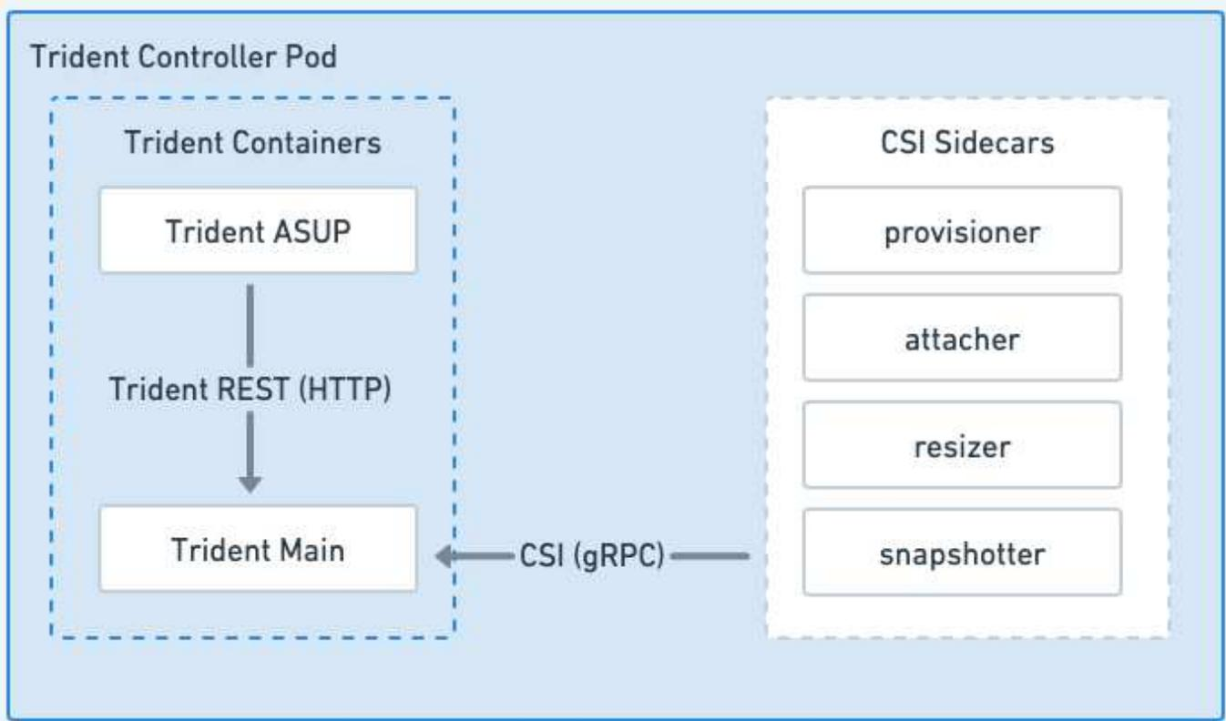
Figure 2. Diagramme du module de contrôleur Trident
