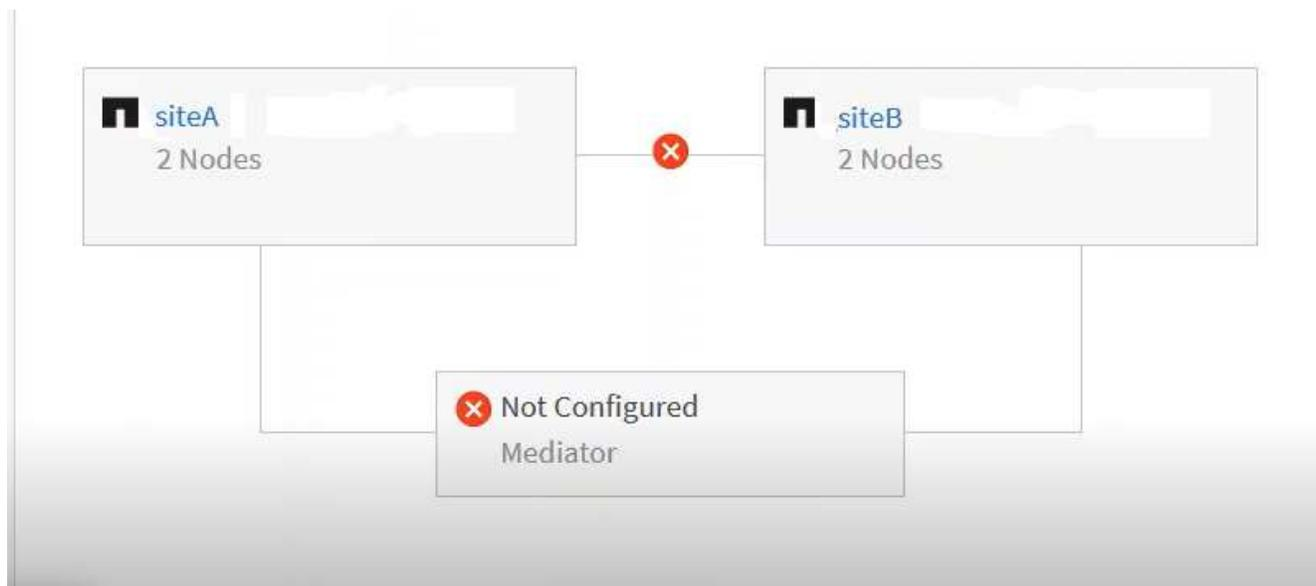
4. Fare clic sull'icona di stato. Viene visualizzato un messaggio con la definizione dell'errore. Se è stato generato un evento per il problema nella configurazione MetroCluster over IP, fare clic sul pulsante **Visualizza evento** sul messaggio e visualizzare i dettagli dell'evento. Una volta risolto il problema e l'evento, l'icona di stato in questa topologia diventa normale ( ).
