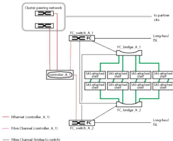
Una configurazione a due nodi include le seguenti connessioni:
