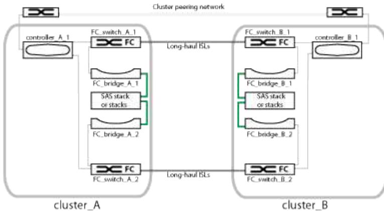
Una configurazione a due nodi è costituita da due cluster, uno per ogni sito separato geograficamente. Cluster\_A si trova nel primo sito MetroCluster. Cluster\_B si trova nel secondo sito MetroCluster. Ogni sito dispone di uno stack di storage SAS. Sono supportati ulteriori stack di storage, ma ne viene mostrato solo uno per ciascun sito.
