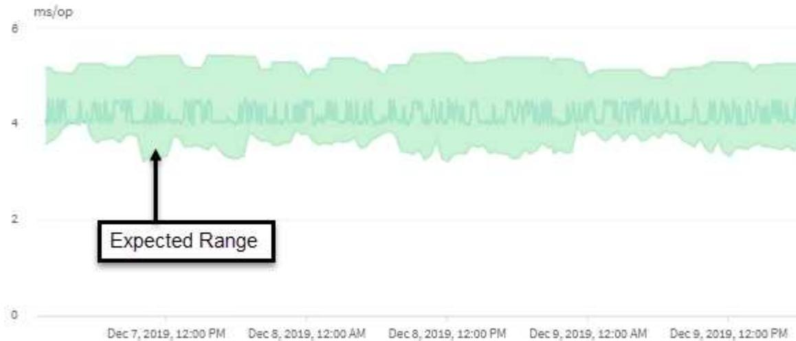
In questo esempio, la latenza per un volume ha una previsione di latenza, in grigio, di 3.5 millisecondi per operazione (ms/op) al minimo e di 5.5 ms/op al massimo. Se la latenza effettiva, in blu, aumenta improvvisamente a 10 ms/op, a causa di un picco intermittente nel traffico di rete o di un conflitto su un componente del cluster, supera la previsione di latenza e supera la soglia di performance dinamica.
