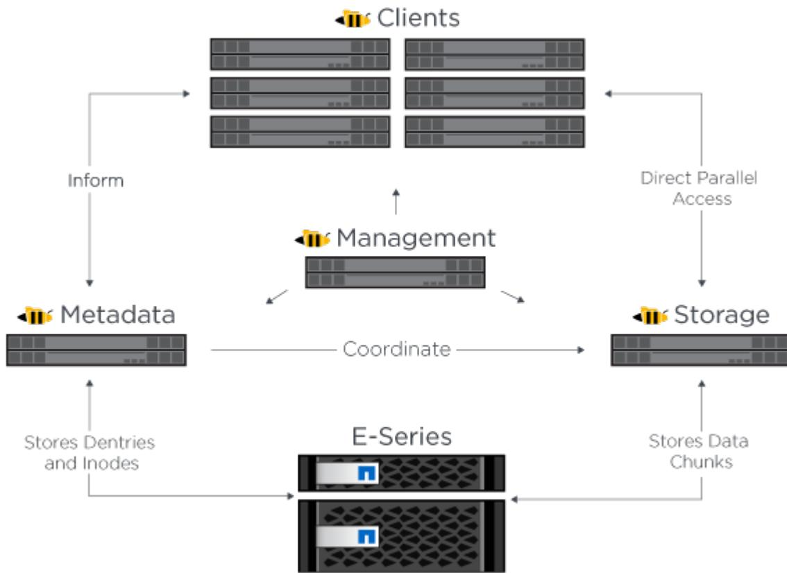
In qualità di file system parallelo, BeeGFS esegue lo striping dei propri file su più nodi server per massimizzare le performance di lettura/scrittura e la scalabilità. I nodi server lavorano insieme per fornire un singolo file system che può essere montato e accessibile contemporaneamente da altri nodi server, comunemente noti come *client*. Questi client possono visualizzare e utilizzare il file system distribuito in modo simile a un file system locale come NTFS, XFS o ext4.
