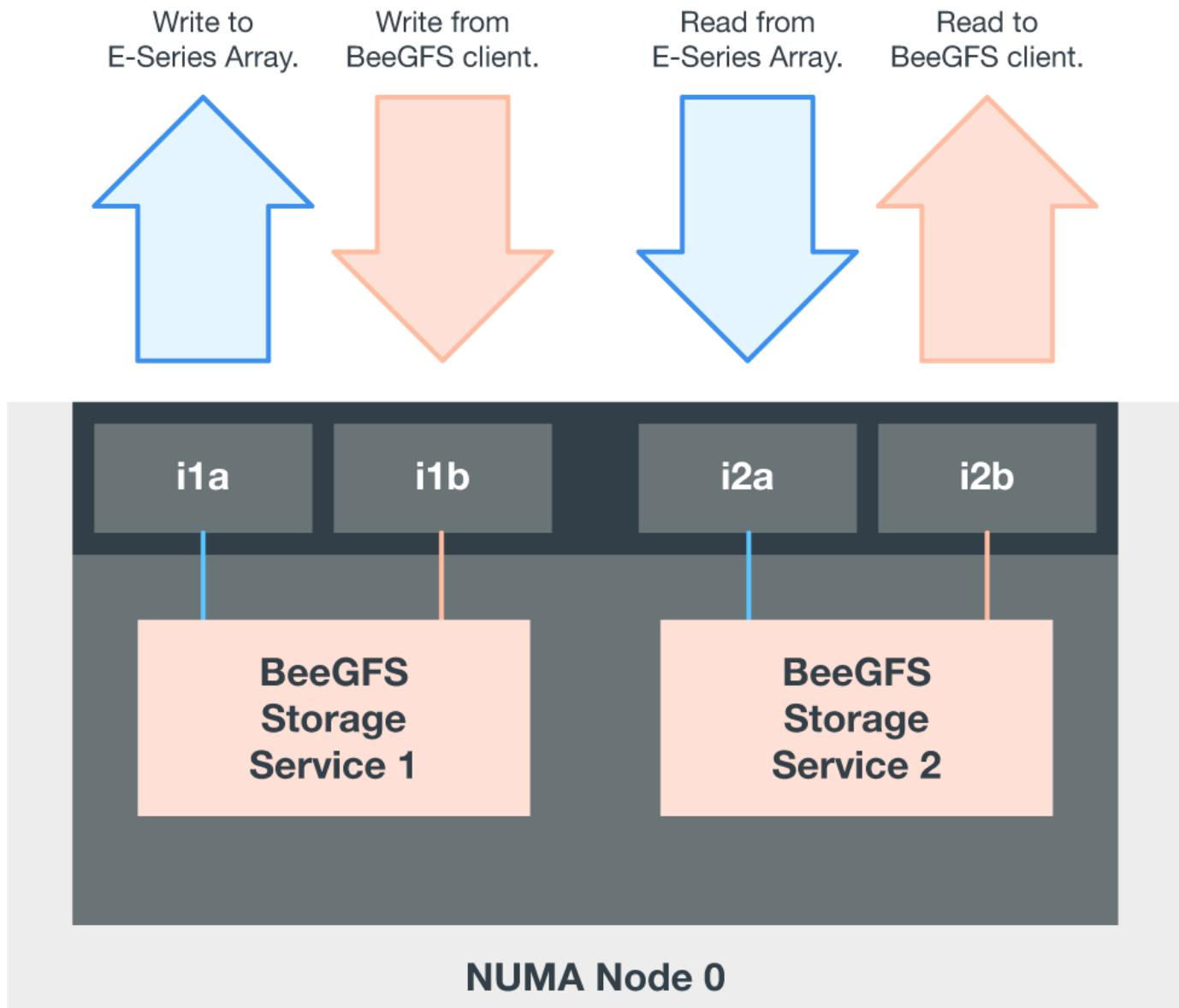
Per ogni servizio BeeGFS, utilizzare lo stesso adattatore per connettere la porta preferita utilizzata per il traffico client con il percorso al controller dei nodi a blocchi che è il principale proprietario di tali volumi di servizi. Per ulteriori informazioni, vedere ["Configurazione del software"](#).
