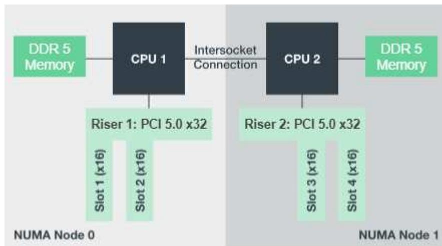
I processi BeeGFS vengono bloccati in una particolare zona NUMA per garantire che le interfacce utilizzate si trovino nella stessa zona. Questa configurazione evita la necessità di un accesso remoto sulla connessione tra socket. La connessione tra socket è talvolta nota come collegamento QPI o GMI2; anche nelle moderne architetture di processore, può essere un collo di bottiglia quando si utilizza una rete ad alta velocità come HDR InfiniBand.
