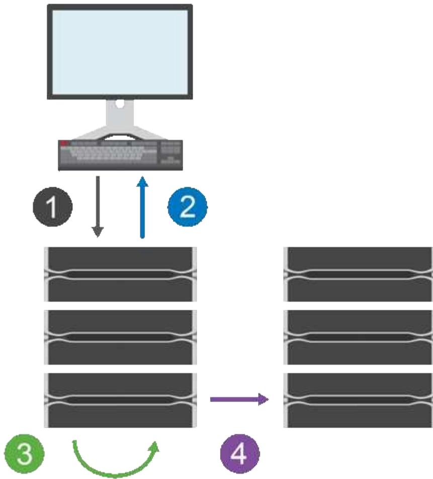
1. Un'operazione di scrittura viene eseguita per prima cosa sull'array di storage del volume primario.
