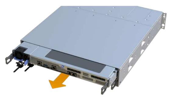
7. Posizionare il contenitore del controller su una superficie piana e priva di elettricità statica.
