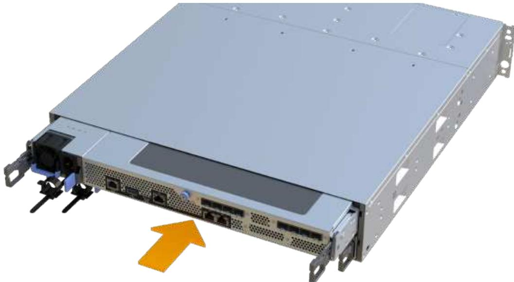
3. Se rimossi, installare gli SFP nel nuovo HIC e ricollegare tutti i cavi. Se si utilizzano più protocolli host, assicurarsi di installare gli SFP nelle porte host corrette.
