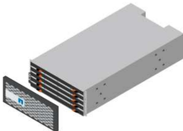
Shelf con dischi installati (pannello in confezione separata)
