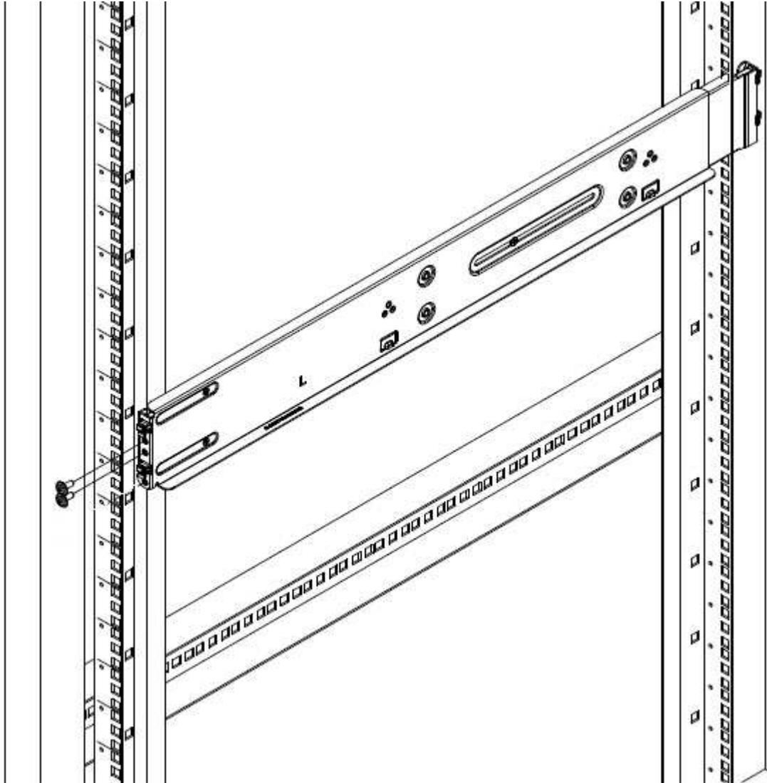
4. Estendere la sezione posteriore della guida fino al montante posteriore del rack.
