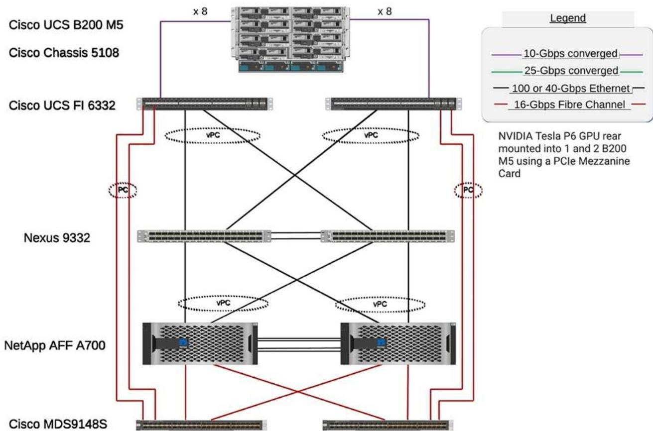
Il seguente diagramma illustra i dettagli del cablaggio FlexPod.
