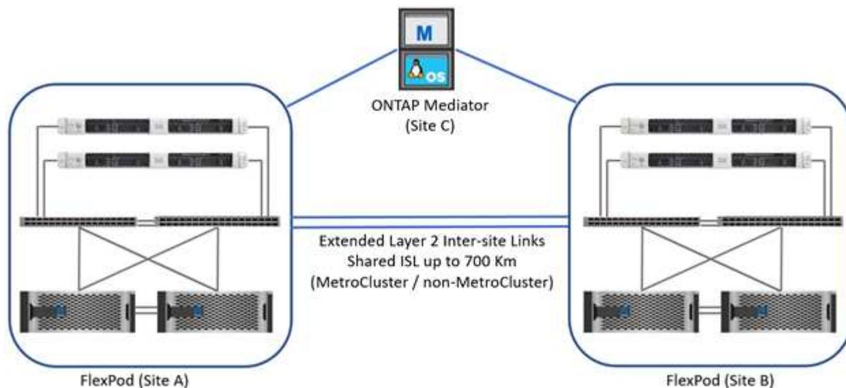
Le due figure seguenti illustrano il fabric VXLAN multi-sito e il fabric di storage IP MetroCluster per una soluzione IP FlexPod MetroCluster con implementazione del fabric VXLAN multi-sito.
