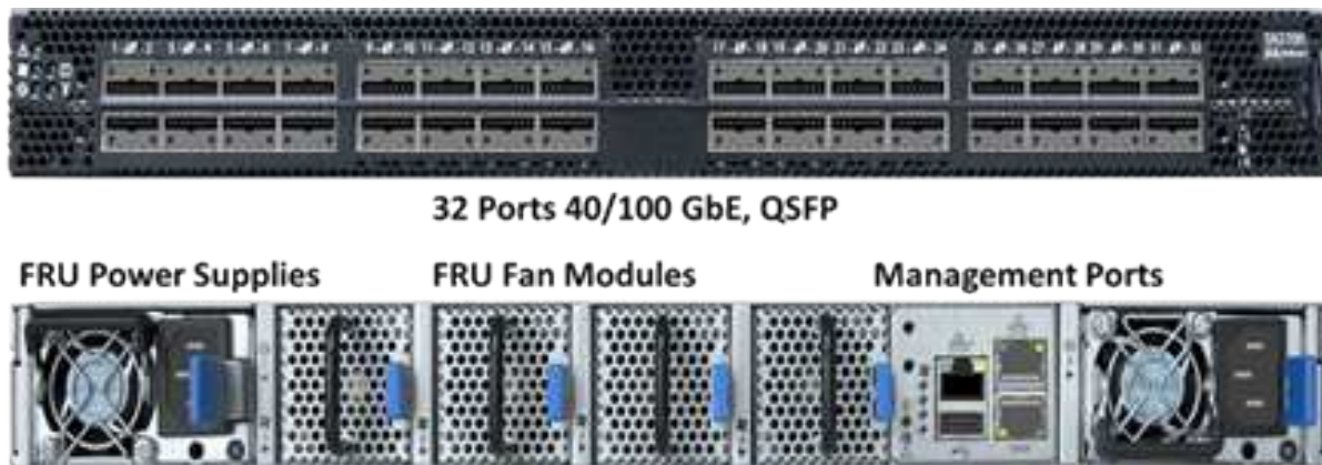
Figura 4. Switch SN2700 anteriore e posteriore
