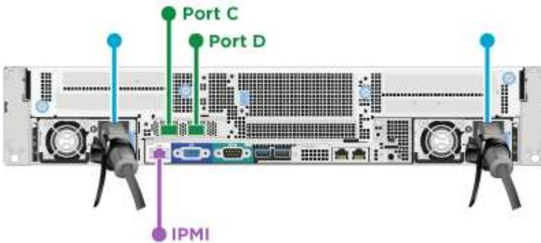
Di seguito sono riportate le porte e le posizioni di rete sul nodo di calcolo H615C:
