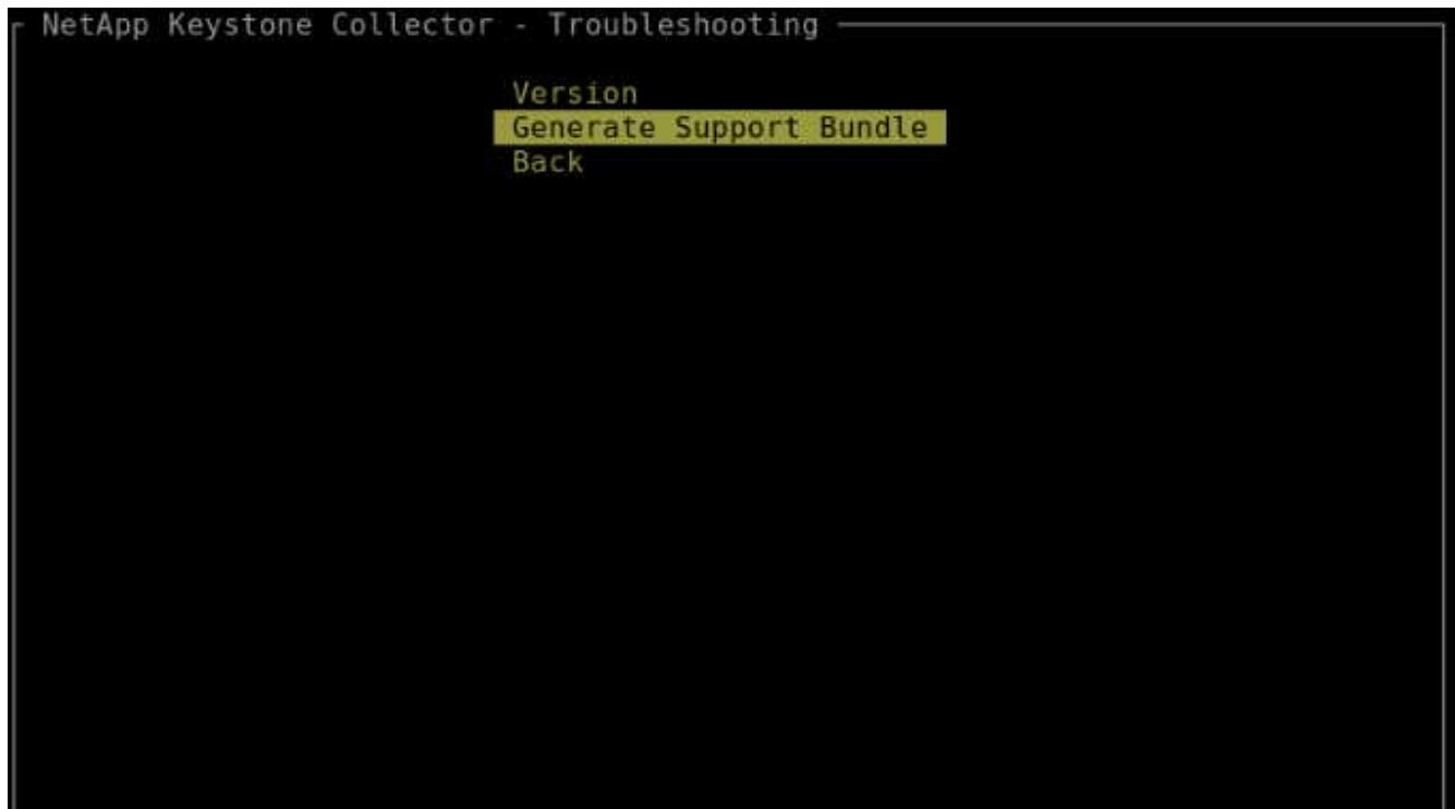
3. Una volta generato, viene visualizzata la posizione in cui il bundle viene salvato. Utilizzare FTP, SFTP o SCP per connettersi alla posizione e scaricare il file di log su un sistema locale.
