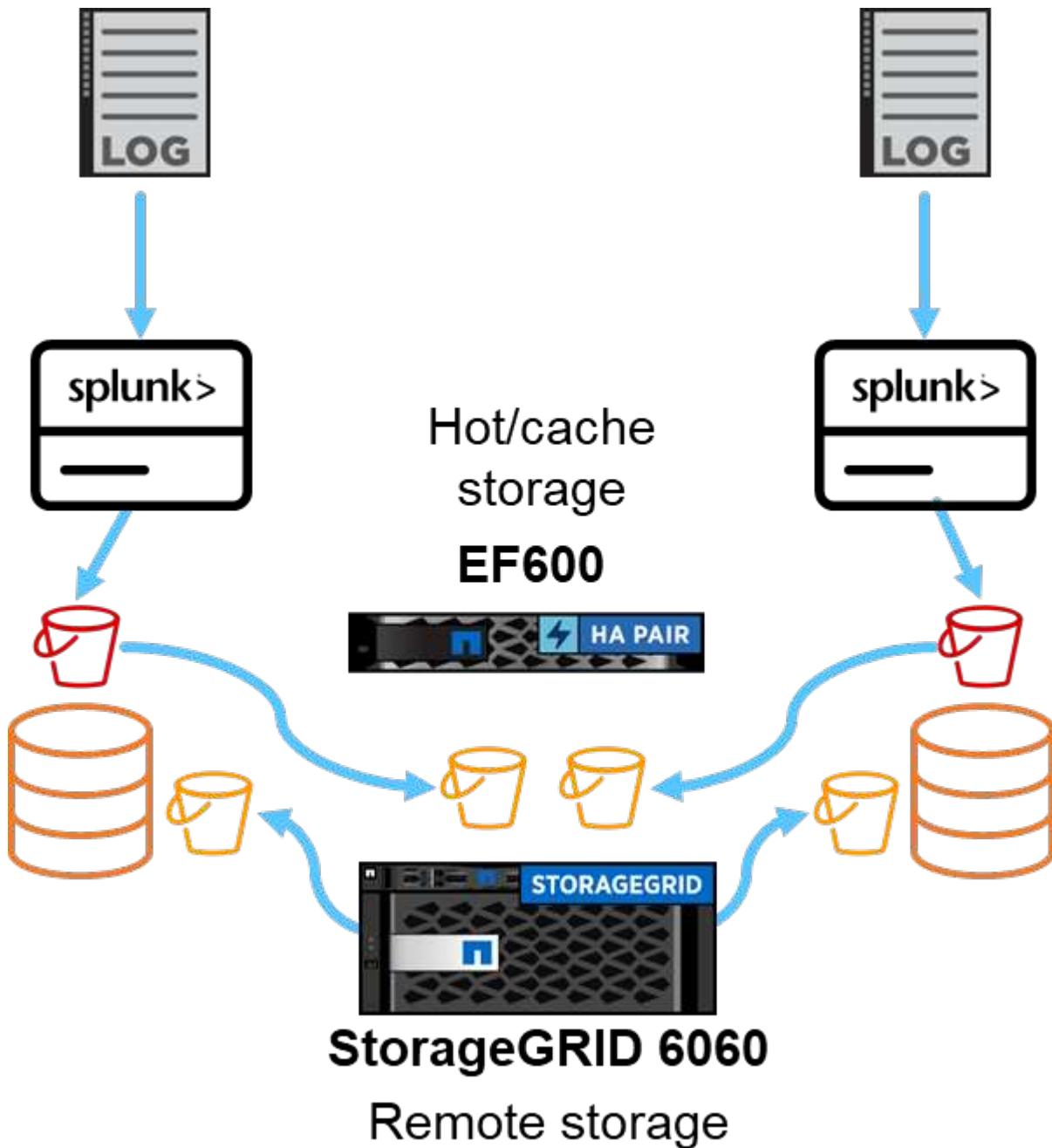
Abbiamo utilizzato EF600 per l'archiviazione hot/cache e StorageGRID 6060 per l'archiviazione remota. Per la convalida delle prestazioni abbiamo utilizzato la seguente architettura. Abbiamo utilizzato due search head, quattro heavy forwarder per inoltrare i dati agli indicizzatori, sette Splunk Event Generator (Eventgen) per generare i dati in tempo reale e 18 indicizzatori per archiviare i dati.
