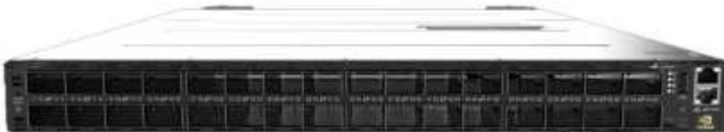
Gli switch NVIDIA Quantum-2 QM9700 con connettività InfiniBand da 400GB GB/s alimentano il fabric di calcolo nelle configurazioni NVIDIA Quantum-2 InfiniBand BasePOD. Gli adattatori a porta singola ConnectX-7 vengono utilizzati per il fabric di calcolo InfiniBand. Ogni sistema NVIDIA DGX ha doppie connessioni a ogni switch QM9700, offrendo percorsi multipli a elevata larghezza di banda e bassa latenza tra i sistemi.
