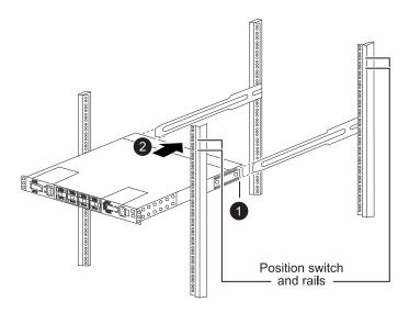
Mentre il telaio viene spinto verso i montanti posteriori, allineare le due guide di montaggio del rack posteriore con le guide scorrevoli
