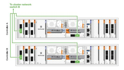
Passaggio 4: cablare le connessioni di archiviazione dal controller allo switch
