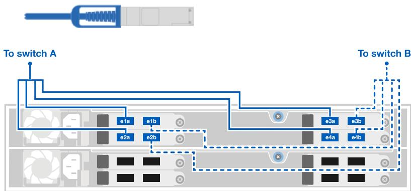
2. Collegare le seguenti porte shelf a qualsiasi porta non ISL sullo switch A e sullo switch B per il modulo B.
