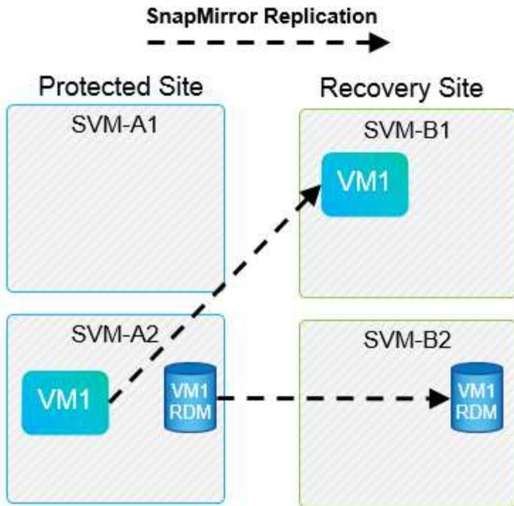
Qualsiasi relazione di replica in cui un singolo volume NetApp viene replicato da una SVM di origine a più destinazioni nella stessa SVM o in SVM differenti viene definita fan-out di SnapMirror. Fan-out non supportato con VLSR. Nell'esempio mostrato nella figura seguente, VM1 non è possibile configurare la protezione in VLSR perché viene replicata con SnapMirror in due posizioni diverse.
