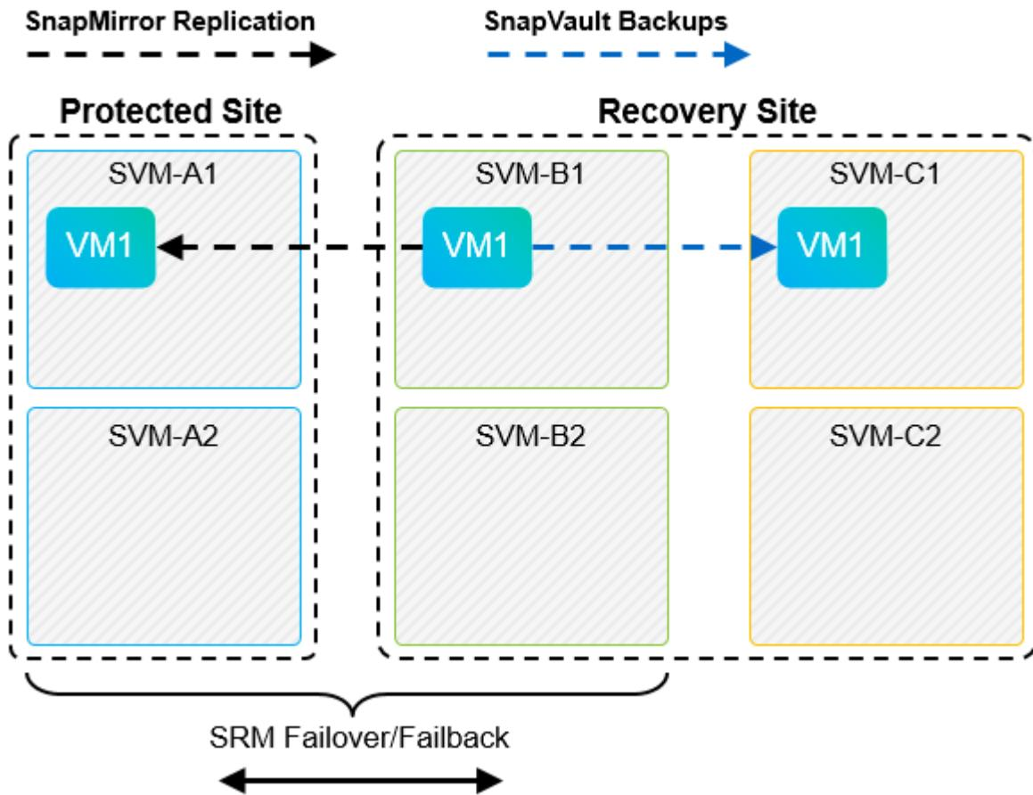
Dopo che vsrm esegue il failback e una seconda inversione delle relazioni SnapMirror, i dati di produzione vengono ripristinati nel sito primario. Questi dati sono ora protetti nello stesso modo in cui erano prima del failover al sito di DR, tramite i backup SnapMirror e SnapVault.
