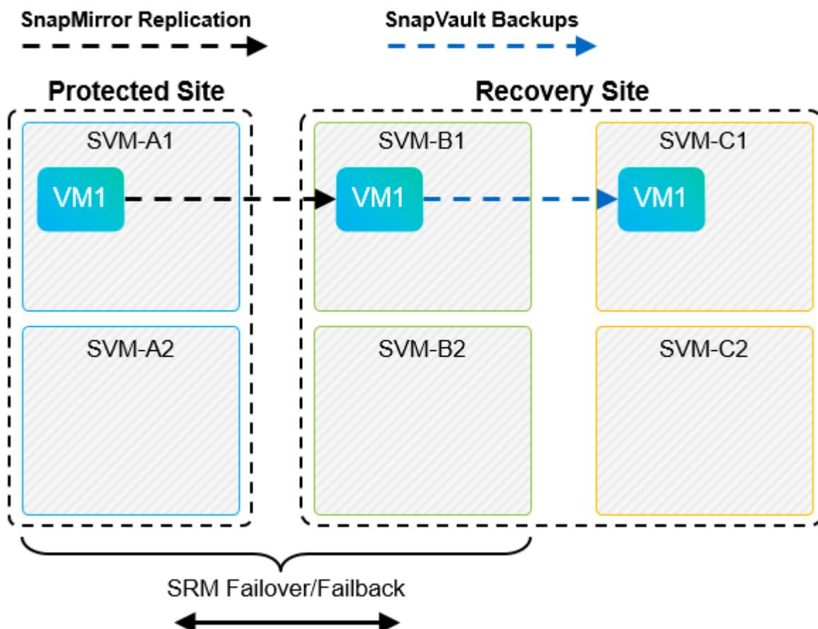
La seguente figura illustra la configurazione dopo l'utilizzo di VLSR per eseguire il reverse della replica di SnapMirror nel sito primario. L'ambiente è stato anche riconfigurato in modo che i backup di SnapVault si verifichino da quella che ora è l'origine di SnapMirror. Questa configurazione è una configurazione fan-out di
