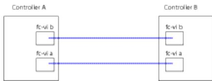
La figura sopra riportata è una tipica rappresentazione del cablaggio richiesto. Le porte FC-VI specifiche variano in base al modulo controller.
