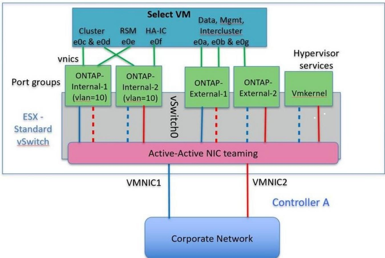
Quando si utilizzano due porte fisiche (10 GB o meno), ciascun gruppo di porte deve disporre di un adattatore attivo e di un adattatore di standby configurati uno di fronte all'altro. La rete interna è presente solo per i cluster ONTAP Select a più nodi. Per i cluster a nodo singolo, entrambi gli adattatori possono essere configurati come attivi nel gruppo di porte esterne.
