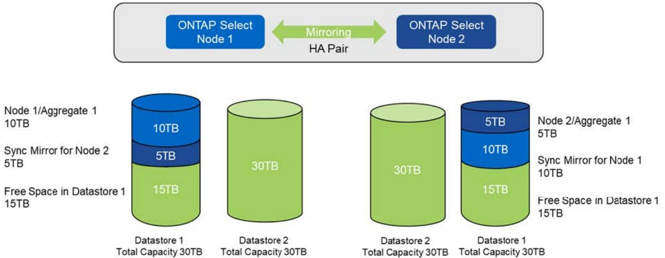
Due operazioni aggiuntive di storage-add sul nodo 1 consumano il resto del datastore 1 e una parte del datastore 2 (utilizzando il limite di capacità). La prima operazione storage-add consuma i 15 TB di spazio libero rimasti nel datastore 1. La figura seguente mostra il risultato della seconda operazione di aggiunta dello storage. A questo punto, il nodo 1 ha 50 TB di dati attivi in gestione, mentre il nodo 2 ha i 5 TB originali.
