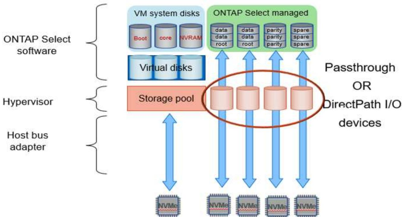
I dischi di sistema (VMDK) risiedono nello stesso datastore e sullo stesso disco fisico. Il disco virtuale NVRAM richiede un supporto rapido e duraturo. Pertanto, sono supportati solo gli archivi dati di tipo NVMe e SSD. Quando si utilizzano unità NVMe per i dati, il disco di sistema deve essere anche un dispositivo NVMe per motivi di performance. Un buon candidato per il disco di sistema in una configurazione All NVMe è una SCHEDA INTEL Optane.
