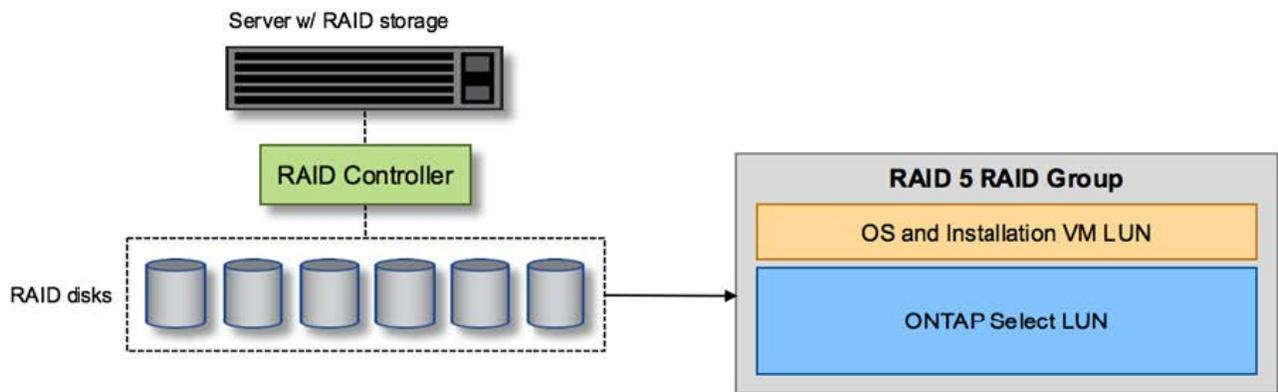
Il provisioning dei LUN del sistema operativo dallo stesso gruppo RAID di ONTAP Select consente al sistema operativo dell'hypervisor (e a qualsiasi macchina virtuale client fornita da tale storage) di beneficiare della protezione RAID. Questa configurazione impedisce che un guasto a un disco singolo causi il blocco dell'intero sistema.
