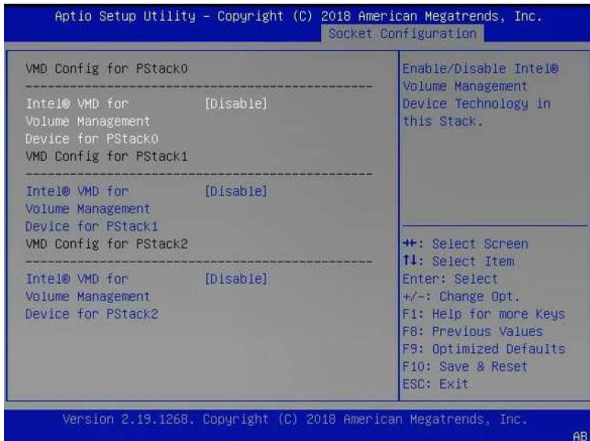
4. Configurare le unità NVMe per il pass-through alle macchine virtuali.
