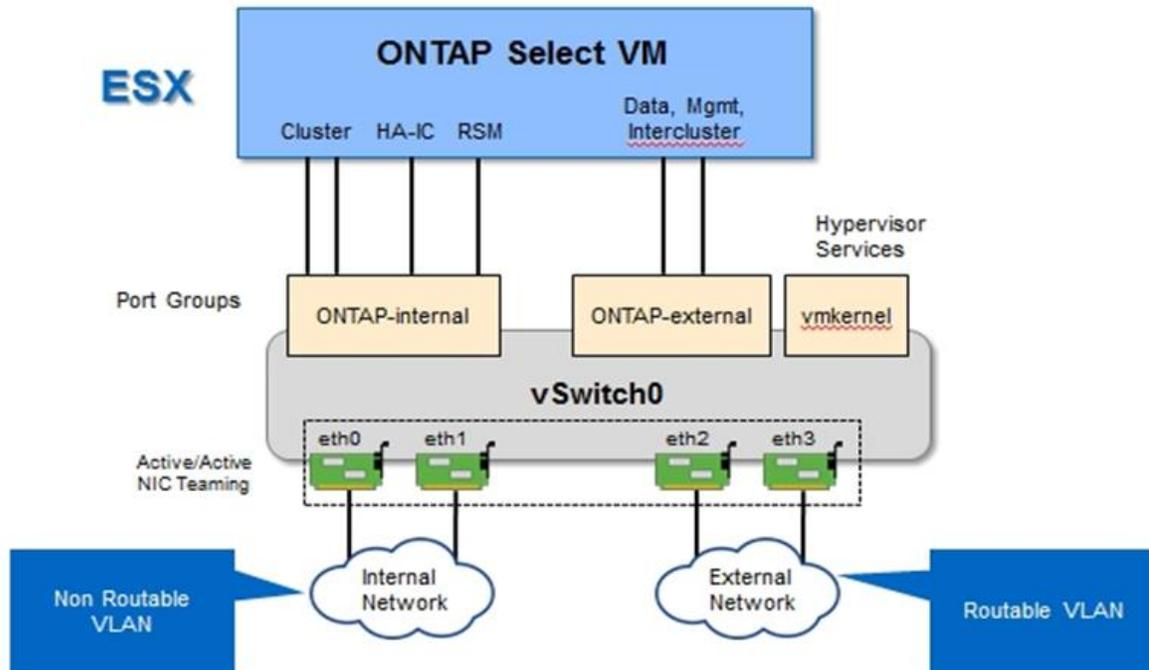
La separazione del traffico interno ed esterno tra diverse schede di rete fisiche impedisce l'introduzione di latenze nel sistema a causa di un accesso insufficiente alle risorse di rete. Inoltre, l'aggregazione tramite il raggruppamento delle schede di rete garantisce che il guasto di una singola scheda di rete non impedisca al nodo del cluster ONTAP Select di accedere alla rispettiva rete.
