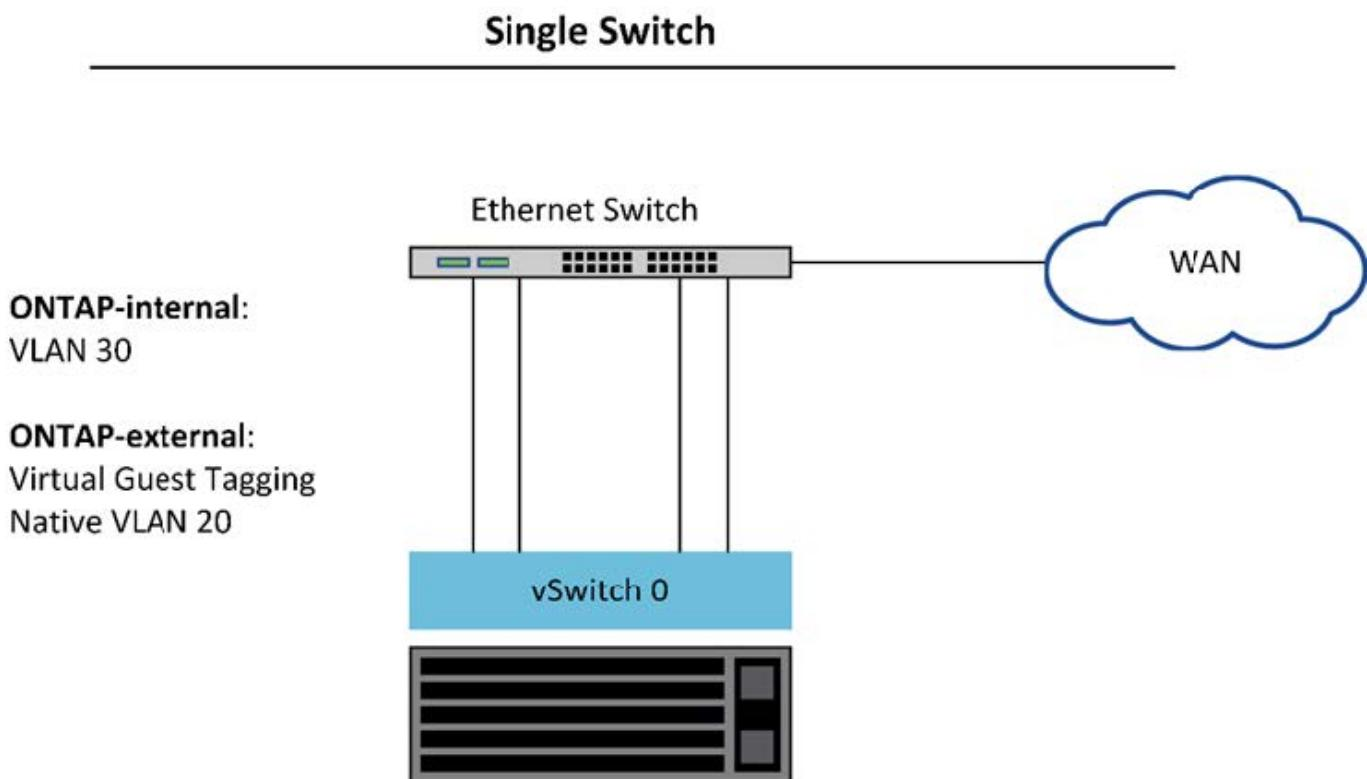
**i** In questa configurazione, lo switch condiviso diventa un singolo punto di errore. Se possibile, è necessario utilizzare più switch per evitare che un guasto fisico dell'hardware causi un'interruzione della rete del cluster.
