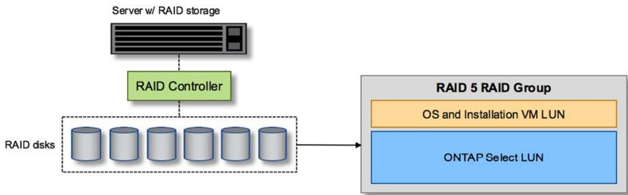
Il provisioning dei LUN del sistema operativo dallo stesso gruppo RAID di ONTAP Select consente al sistema operativo dell'hypervisor (e a qualsiasi macchina virtuale client fornita da tale storage) di beneficiare della protezione RAID. Questa configurazione impedisce che un guasto a un disco singolo causi il blocco dell'intero sistema.
