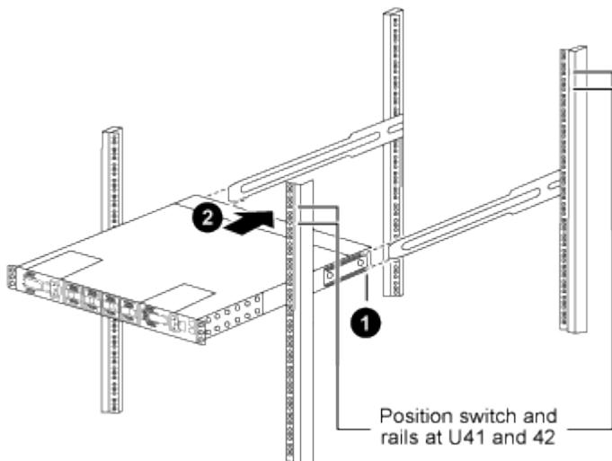
(1) Mentre il telaio viene spinto verso i montanti posteriori, allineare le due guide di montaggio posteriori del rack con le guide scorrevoli.
