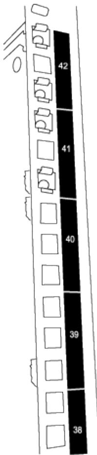
I due switch 3232C saranno sempre montati nella parte superiore 2U dell'armadio RU41 e 42.
