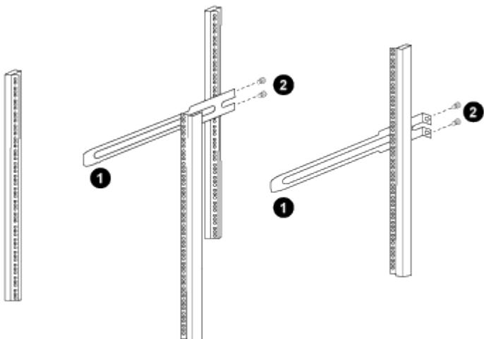
(1) Mentre fai scorrere delicatamente la guida scorrevole, allineala ai fori delle viti nel rack. + (2) Stringi le viti delle guide scorrevoli ai montanti del mobile.
