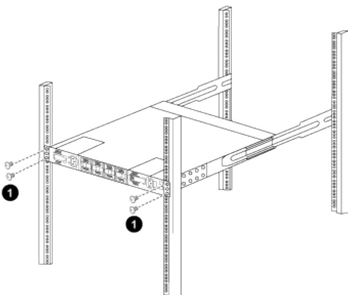
(1) Mentre una persona tiene in piano la parte anteriore del telaio, l'altra persona deve stringere completamente le quattro viti posteriori ai montanti del mobile.
